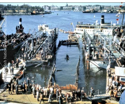
Bild 3. Um das Wrack der Vasa zu bergen, mussten sechs Tunnel unter dem Schiff gegraben werden. Dort wurden Stahlkabel hindurchgeführt, an denen die Vasa mithilfe zweier Bergungspontons gehoben wurde. Am 24. April 1961 erreichen die ersten Holzteile die Wasseroberfläche.
